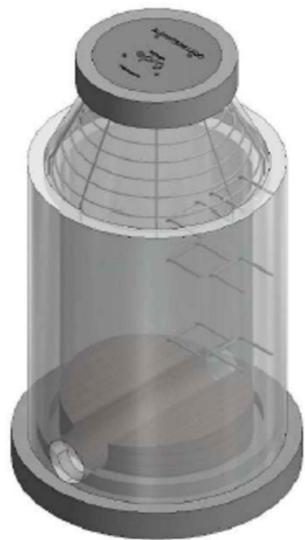
POZO DE INSPECCION Ø1,20m CONCENTRICO VISTA ISOMETRICA
