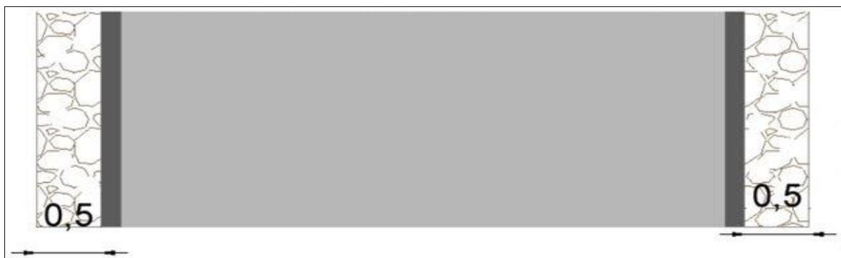
Ilustración 1: Detalle protección lateral concreto ciclópeo.
