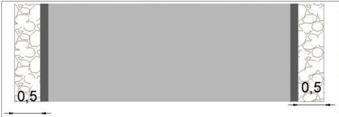
Ilustración 23: Detalle protección lateral concreto ciclópeo.
