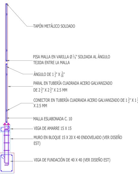
SECCIÓN TÍPICA CERRAMIENTO EN MALLA ESLABONADA ESCALA 1:20
