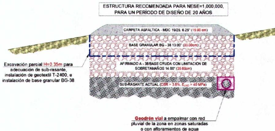
Ilustración 28. Unidad de diseño típica para presiones de inflado de llanta de 100 psi. NESE=1,000,000
