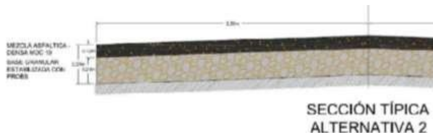
Figura 2. Estructura del pavimento seleccionada
