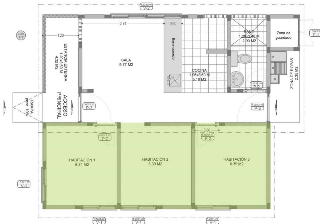
Esta distribución posibilita la separación de las áreas de descanso con las áreas húmedas a través de un corredor y los muros de división de las habitaciones. Estos últimos no presentan tuberías ni otros elementos que puedan generar ruido u olores que afecten el sueño.
