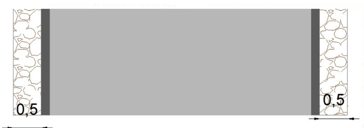
Ilustración 18 Detalle de protección en concreto ciclópeo.
