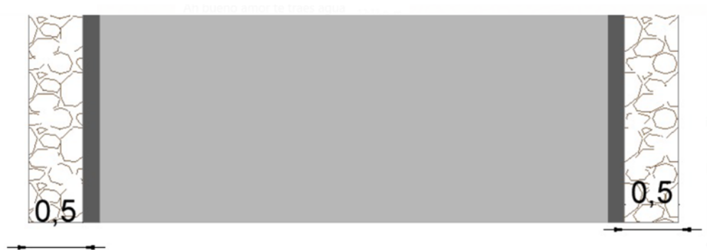
Ilustración 32 Detalle de protección e concreto ciclópeo
