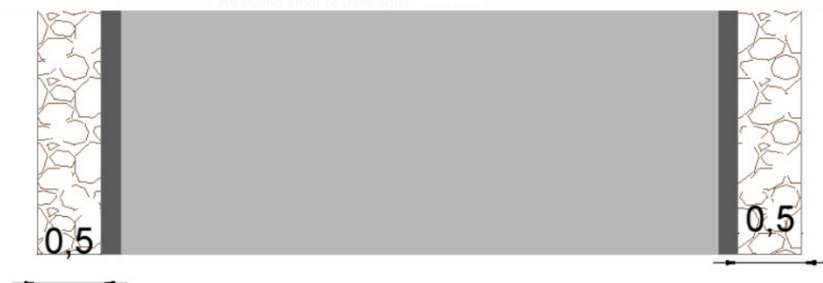
Ilustración 2 Detalle de protección en concreto ciclópeo.
