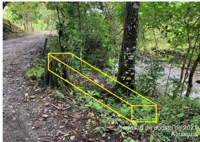
Ilustración 8 Propuesta Gavión 1 (H: 1.0 m, L: 5.0 m, b: 1.0 m). Vía Polines – Carepa
