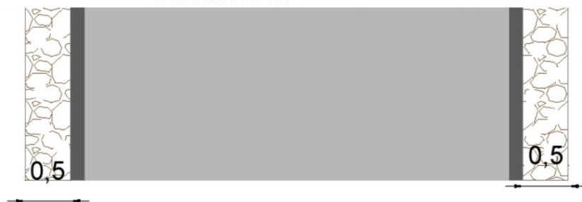
Ilustración 25 Detalle de protección e concreto ciclópeo.
