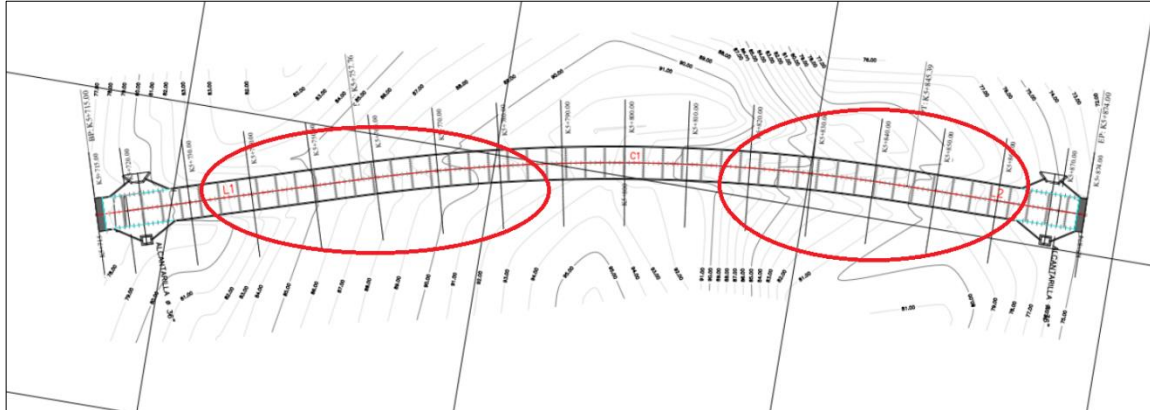
Ilustración 15 Ubicación de zonas críticas de erosión Remigio – Chigorodó- tramo 2
