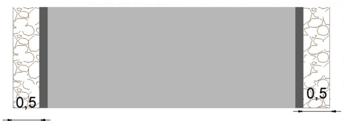
Ilustración 36 Detalle de protección en concreto ciclópeo.
