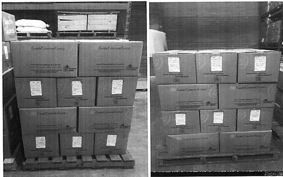
Imagen 4. Estibas de 1.45 mt X 1.30 mt con voladizo interno, con arrume de cajas de 1.20 mt X1.20 mt.
