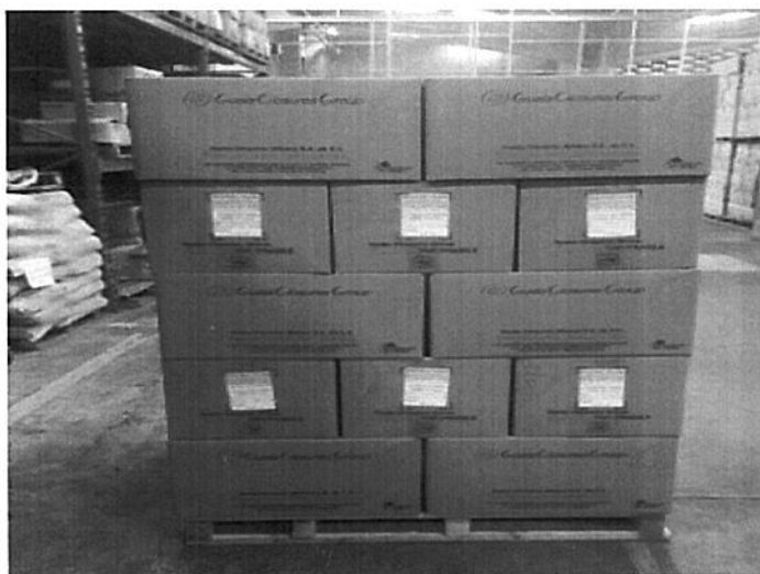
Imagen 7. Pallet con estiba de 1.20 mt X 1.20 mt, arrume alineado y sin voladizo.
