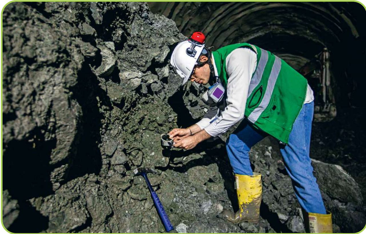
El método de clasificación RMR arroja un puntaje, según las condiciones evaluadas en el frente de excavación.
