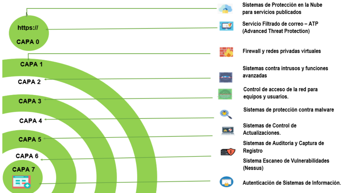
Ilustración 13 Cobertura de seguridad a las Capas de Red del Modelo OSI
