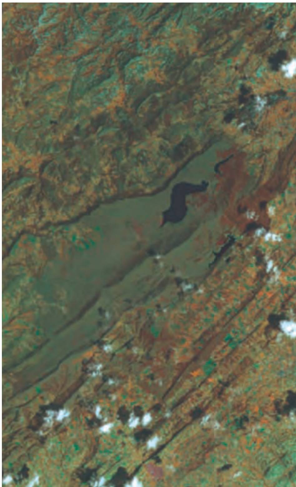
▲ Imagen de satélite Landsat TM Path/Row 8/56 (tomada en febrero de 2000, en combinación RGB 453). Los polígonos más oscuros corresponden a los embalses de Gachaneca y Teatinos, rodeados por plantaciones forestales (en café oscuro) y páramo (en verde oscuro) en la zona oriental. Unidad de SIG, IAvH.
